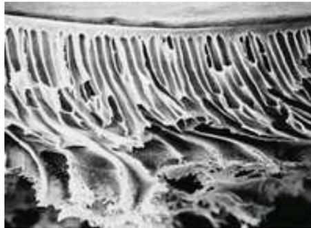
Abbildung 3.4: Elektronenmikroskopische Aufnahme der Millipore 3kDa NMWL Membran [29]
