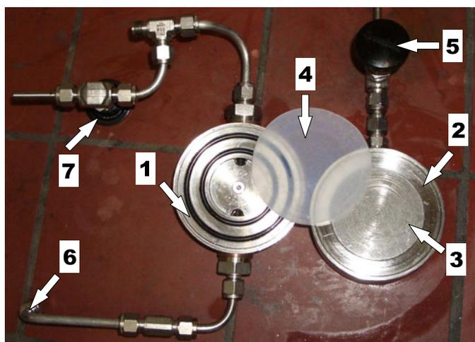
Abbildung 3.3: Membranmodul. 1: Gehäuseoberteil, 2: Gehäuseunterteil, 3: Sinterplatte, 4: Membran, 5: Permeatventil (V6), 6: Retentatseitiger Anschluss, 7: Feedentnahmeventil (V5)
