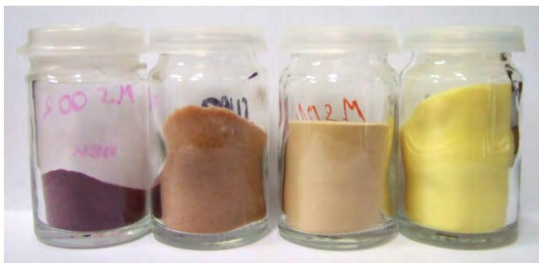
Abbildung 3.2: Vier ungebrauchte SILP Katalysatoren für die Hydroformylierung mit unterschiedlichen Liganden und Rhodiumbeladungen.
