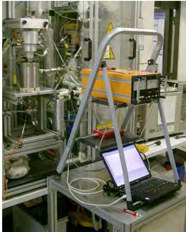
Abbildung 3.11: Versuchsaufbau zur Messung der Verweilzeitverteilung des Berty-Reaktors. In Orange ist der Binos Gasdetektor zu erkennen. Die Interface Box ist rot.
