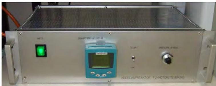
Abbildung 3.8: Regelungseinheit des Berty-Reaktors
