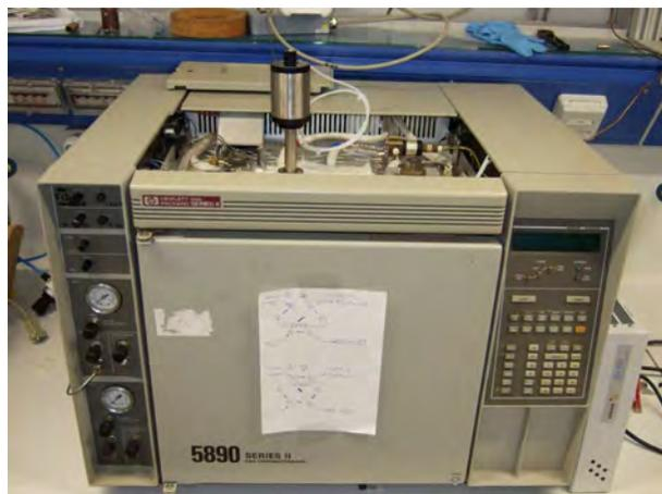
Abbildung B.5: Umgerüsteter GC für den Berty Versuchsstand. Oben ist das 6-Port Vici Ventil zu erkennen, Links das Rechner-Interface.
