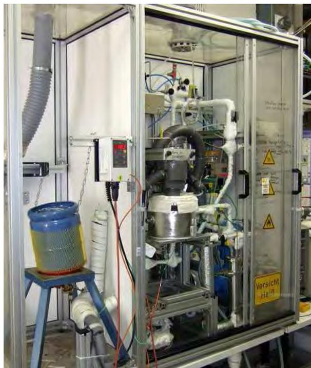
Abbildung 3.9: Die kontinuierliche SILP-Anlage mit Berty-Reaktor
