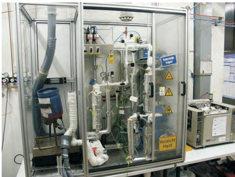
Abbildung 3.3: Ansicht der kontinuierlichen SILP-Anlage
